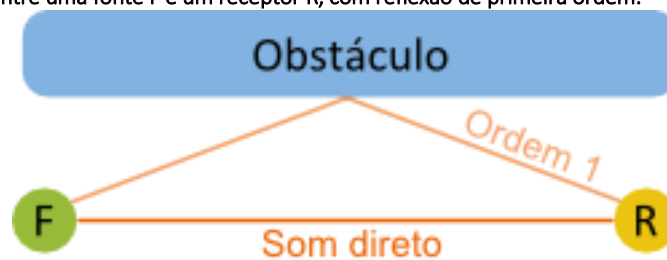
Figura 6 - Propagação do som entre uma fonte F e um receptor R, com reflexão de primeira ordem.
